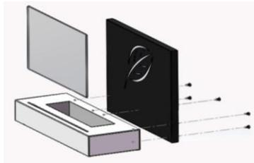
3. Fissare la staffa al muro utilizzando le viti e i tasselli. Attenzione: il camino deve essere fissato solo su un muro solido e di materiale non infiammabile.
